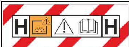
VARNING: Denna maskin innehåller hälsovådligt damm. Tömning och underhåll, inklusive borttagning av dammpåsen, får endast utföras av kompetenta personer som bär lämplig skyddsutrustning. Använd inte maskinen utan hela filtreringssystemet.
