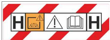
ATTENZIONE: Questa macchina contiene polvere dannosa per la salute. Le operazioni di svuotamento e di manutenzione, compresa la rimozione dei serbatoi di raccolta delle polveri, possono essere eseguite solo da specialisti che indossano gli appositi dispositivi di protezione. Non mettere in funzione l'apparecchio senza il sistema di filtraggio completo.
