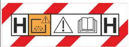
警告：本机器含有损害健康的粉尘。清空和保养过程中，其中包括清除粉尘收集容器，只能由穿戴相应防护装备的专业人员进行操作。在没有完整的过滤系统情况下不得运行设备。
