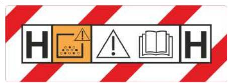
**ADVERTENCIA:** Esta máquina contiene polvo perjudicial para la salud. Solo personas formadas y con un equipo de protección adecuado deben llevar a cabo tareas de vaciado y mantenimiento, incluida la eliminación de los recipientes colectores de polvo. No utilizar sin el sistema de filtrado completo.
