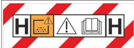
**VÝSTRAHA:** Tento stroj obsahuje zdraviu škodlivý prach. Vyprázdenie a údržbu, vrátane odstránenia zberného vrecuška na prach smú vykonávať iba odbornici, ktorí používajú vhodnú ochrannú výbavu. Neprevádzkujte ho bez kompletného filtračného systému.
