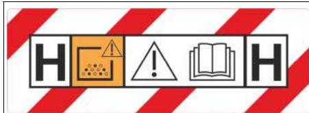
**UPOZORENJE:** Ova mašina sadrži prašinu koja je opasna po zdravlje. Postupak pražnjenja i održavanja, uključujući uklanjanje vrećice za sakupljanje prašine, sme da izvodi samo stručno osoblje, koje nosi odgovarajuću zaštitnu opremu. Nemojte koristiti uređaj bez kompletног sistema za filtraciju.
