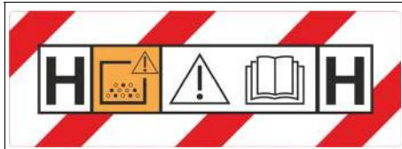
**VAROVÁNÍ:** Tento stroj obsahuje zdraví škodlivý prach. Jeho vyprazdňování a údržbu včetně odstranění prachových nádob smí provádět jen odborníci, jež nosí příslušné ochranné pracovní prostředky. Neprovozujte přístroj bez úplného filtračního systému.
