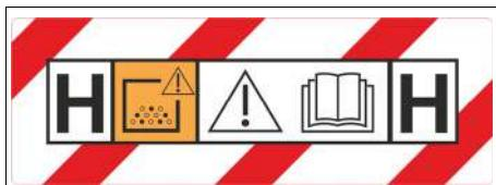
ADVERTÊNCIA: Esta máquina contém pó perigoso para a saúde. Os processos de esvaziamento e manutenção, incluindo a remoção do recipiente colector de pó, só podem ser efectuados por profissionais experientes envergando equipamento de protecção adequado. Não utilizar sem o sistema de filtração completo.
