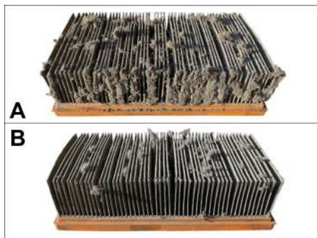
A Filtro de pregas antes da limpeza
