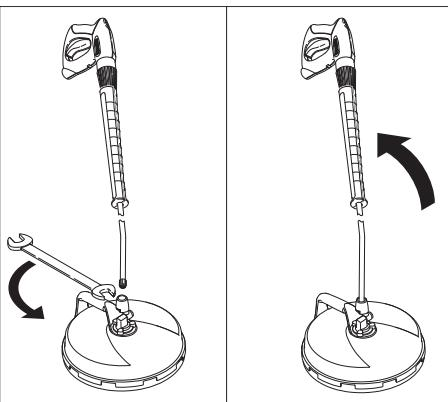
→ Raccorder le jet haute pression à FR Basic et le serrer à l'aide de la clé (d'ouverture de 24).
