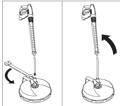
→ Priklučiti metalnu cev prečistača pod visokim pritiskom na FR Basic i sa ključem za navrtke (širina ključa 24) čvrsto zategnuti.
