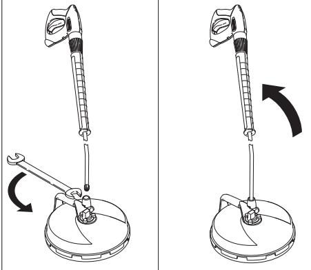
→ Prúdovú rúrku vysokotlakového čistiaceho prístroja pripojte na FR Basic a pevne dotiahnite pomocou kľúča (veľkosť kľúča 24).
