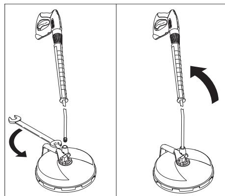
→ Strahlrohr des Hochdruckreinigers am FR Basic anschließen und mit Schraubenschlüssen (Schlüsselweite 24) festziehen.
