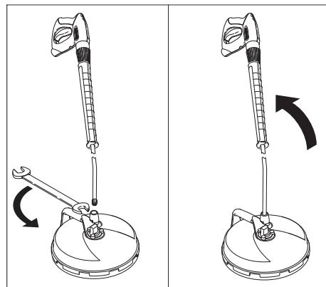
→ Тръбата за разпръскване на уреда за почистване с високо налягане да се присъедини на FR Basic и да се затегне с отвертка (размер на ключа 24).
