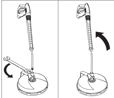
→ Cijev mlaznice uređaja za čišćenje pod tlakom FR Basic priključiti i pritegnuti ključem (razmak ključa 24).
