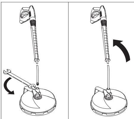
→ Надіти трубку очищувача високого тиску на FR Basic та закрутити гайковим ключем (ключ на 24).
