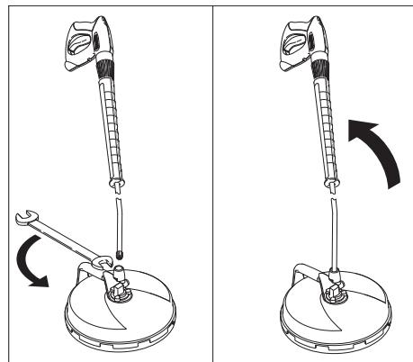
→ Tilslut højtryksrenserens strålerør til FR Basic og skru det fast med skruenøglen (nøglebredde 24).
