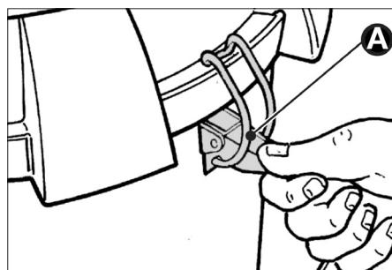
→ Odoberte vysávaciu hlavu. Dbajte na to, aby sa sieťový kábel nepoškodil.
