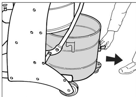
→ Nádobu na nečistoty vyťahnite z vysávača pomocou na to určeného držiaka.
