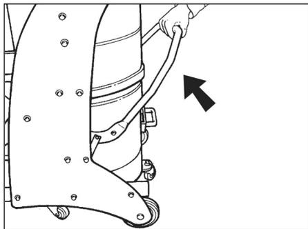
→ Nádobu na nečistoty otvorte pohybom smerom hore (viď obrázok).
