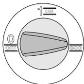
Om het apparaat in te schakelen, heeft u de keuze tussen schakelstand „1/ON“ en „eco“.
