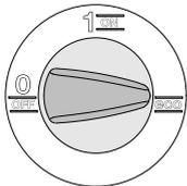
Seadme sisselülitamiseks on lüliti asendid „1/ON“ ja „eco“.
