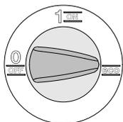
For å slå på maskinen brukes bryterstilling "1/ON" og "eco".
