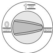
За да включване на уреда има положение на шалтера „1/ON“ и „есо“.
