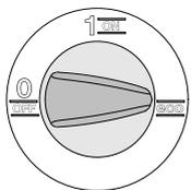
Чтобы включить устройство следует установить выключатель в положение „1/ON“ и „есо“.
