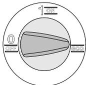
W celu włączenia urządzenia istnieje pozycja przełącznika „1/ON” i „eco”.
