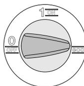
Pokud chcete zapnout přístroj, můžete přepnout přepínač do polohy „1/ON“ a „eco“.
