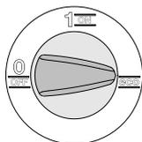
Afbyrderpositionerne „1/ON“ og „eco“ er beregnet til at tænde for maskinen.
